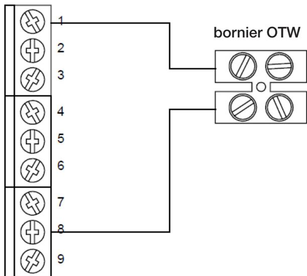
Raccorder le OTW aux bornes #1 & 8 du HRM ou HDM.
