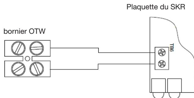
Raccorder le OTW directement au bornier TB6 de la plaquette du circuit imprimé du SKR.
