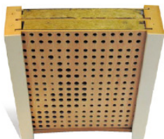
Piège à sons : Composé d'une âme centrale isolante en fibres durs (ép.6mm), de 2 couches de laine de roche et 2 parements décor en MDF
