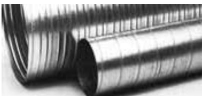
Conduits et accessoires de ventilation métalliques en acier galvanisé, en inox ou en aluminium (NF EN 1506 dimensions et NF EN 12237 résistance et étanchéité). Accessoires de réseaux aérauliques équipés d'un joint EPDM double lèvre serti (6 dimensions suivant diamètre) à chaque extrémité. Ils compensent les éventuelles déformations de conduits et garantissent l'étanchéité à l'air du réseau.
