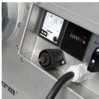
Le panneau de commandes, équipé d'un compteur et d'un connecteur pour l'hygrostat est facile d'utilisation. Il est encastré et parfaitement protégé.
